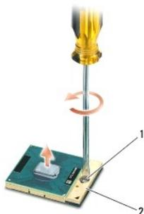
1 кулачковый винт гнезда с нулевым усилием сочленения 2 гнездо с нулевым усилием сочленения
